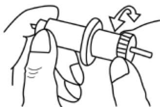
④ Wsuń końcówkę ostrza o wymaganą siłę naciągnięcia dla pożądanego materiału tnącego (T < 5mil).
