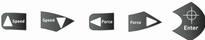
Um den korrekten Ausgangspunkt zum Plotten zu setzen, bewegen Sie im Offline-Modus den Messerkopf und die Folie so, dass sich das Messer in der vorderen rechten Ecke der Folie befindet. Bestätigen Sie nun diesen Nullpunkt durch Drücken des Fadenkreuzes, dadurch wechselt das Gerät auch automatisch in den Online-Modus.
